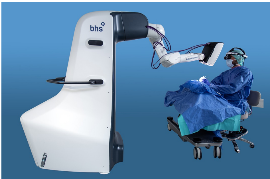
Das 3D-Operationsmikroskop RoboticScope wird mit Kopfbewegungen gesteuert und zeigt wechselnde Blickwinkel (Bild: bhs-technologies).
