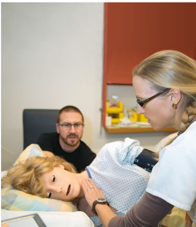
Victoria ist ein Gebärsimulator mit blonder Perücke: aussen viel Silikon, innen Hightech. Die Puppe kann atmen, hat Puls und Blutdruck und mit Hilfe eines Motors im Bauchraum kann sie ein Baby gebären.
